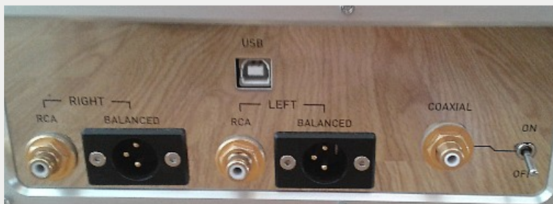
Connectique symétrique et asymétrique « top niveau » fabriquée sur cahier des charges pour YBA. Entrée USB 24 bits – 192 kHz et sortie coaxiale débrayable.
