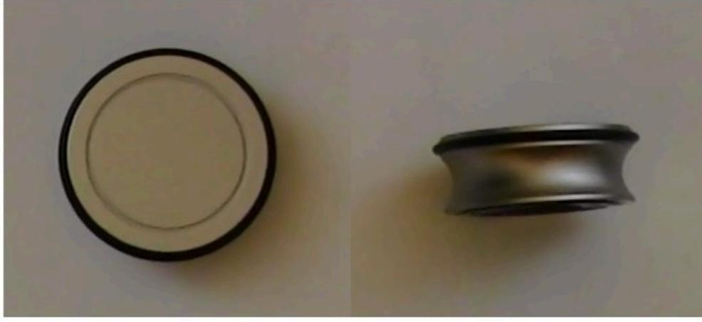
Le compact disque est plaqué sur son support rotatif par un palet presseur magnétique qui contrairement à celui du PASSION CD 430 est très léger. Comme celui du CD 430, ce palet presseur est cerclé d'un joint torique en caoutchouc qui joue un rôle d'amortisseur spécifique.
