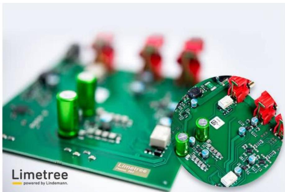
Limetree Phono II possède deux étages séparés pour chaque type de cellule. Selon le concepteur, sa conception rejoint celle des circuits de l'ère des amplis à tubes classiques. Mais ce concept en est une toute nouvelle interprétation utilisant les dernières technologies et composants.
