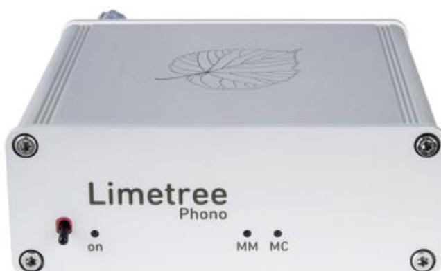
La face avant est dépouillée à l'extrême. Elle ne comporte qu'une unique clef qui sert d'interrupteur de mise sous tension et de choix du type de cellule utilisée : MM ou MC. Le changement de type de cellule s'effectue par une pression de trois seconde sur ladite clef. Trois Leds de couleur jaune égayent cette minuscule face avant en indiquant que l'appareil est opérationnel et le type d'entrée MM ou MC sélectionné.
