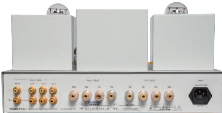
**Sous les transformateurs, la connectique :** une entrée ligne directe à l'ampli de puissance et trois entrées lignes classiques. Sur la droite, les sorties de puissance se déclinent dans les trois impédances de charge recommandées en sortie des transformateurs de modulation, soit 4, 8 et 16 ohms.
