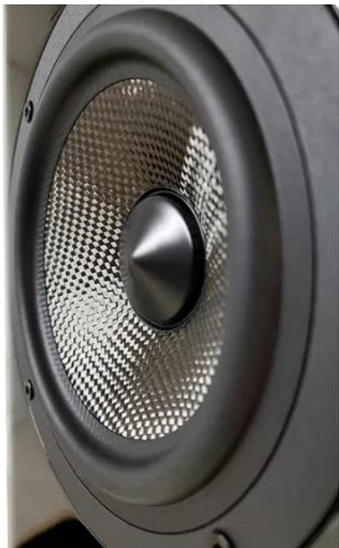
Le haut-parleur de grave / médium de 12,5 centimètres de diamètre possède également une membrane en fibre de carbone. Il comprend de nouvelles bobines acoustiques surdimensionnées de 35 millimètres pour une faible compression thermique et un facteur de force moteur très élevé afin de fournir une réponse des fréquences graves hautement dynamique mais contrôlée.
